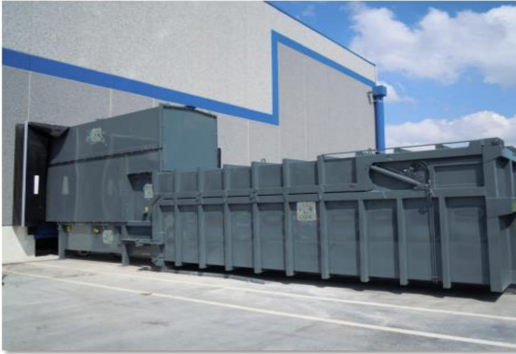
Figura 15 – Container abbinato a pressa stazionaria
