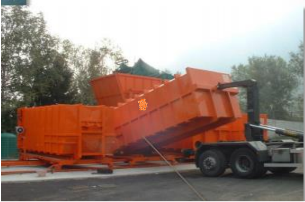
Figura 17 – Fase di cambio cassone con sistema di traslazione a binario e carrelli
