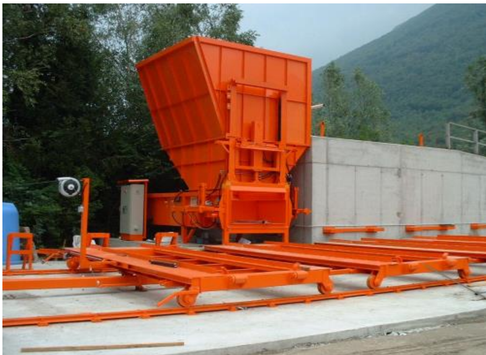
Figura 16 – Particolare di binari per movimentazione semiautomatica dei carrelli sui quali vengono posti i container da riempire mediante pressa stazionaria
